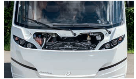
» I: Servicevriendelijk: grote motorkap, goed bereikbaar voor alle servicegerelateerde werkzaamheden
