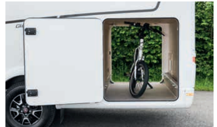
» Hoge en van beide kanten bereikbare garage met 150 kg draagvermogen. Standaard uitgevoerd met 2 luiken
