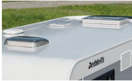
» Goed beschermd tegen hagel met het bestendige GFK dak
