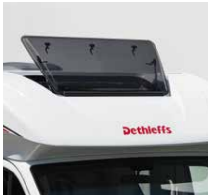
Al aanwezig: groot, openklapbaar raam in de kap boven de cabine
