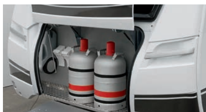
» Stevige, geribbelde aluminium bodem en verticaal te openen disselbakklep
