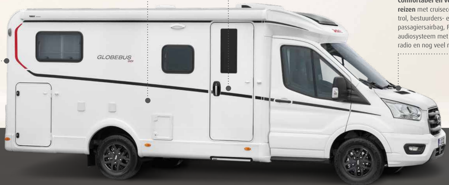
Dak, achterzijde en zijwanden van sterk GFK-materiaal.
