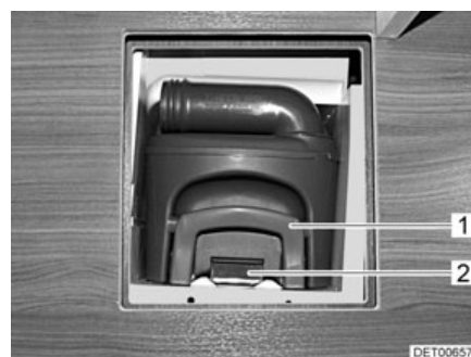
Afb. 262 Toegang fecaliëntank, geopend
