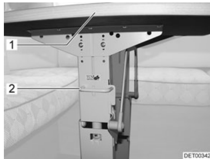
Afb. 61 Vergrendeling zwenktafel met metalen frame
