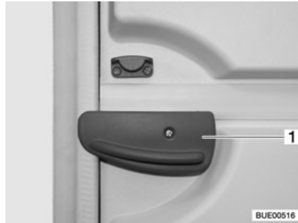
Afb. 25 Vergrendelingshendel aan het onderste deel van de deur
