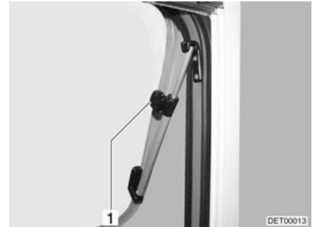
Afb. 36 Uitzetbaar raam met draaibare uitzetters, geopend
