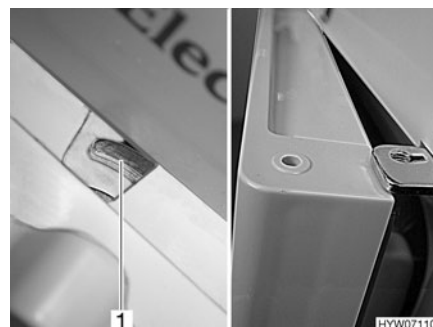
Afb. 200 Koelkastdeur/vriesvakdeur in ventilatiestand (Dometic 7-serie met apart vriesvak)
