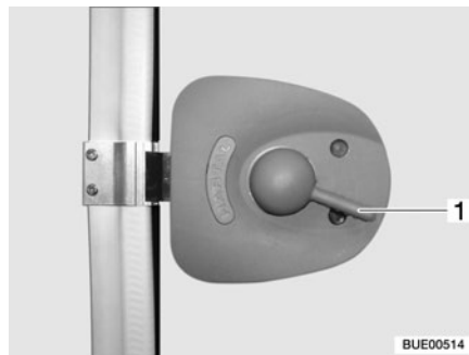
Afb. 23 Deurslot ingangsdeur, binnen, open
